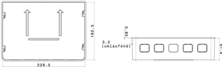
Um die Funk-Kommunikation zu verbessern, kann eine externe Antenne angeschlossen werden. Bei der Installation sollte darum ein **50 cm langes Leerrohr** unterhalb des Unterputzkastens angebracht werden, in dem die externe Antenne platziert werden kann (Gesamtgröße der Antenne ca. 565 x 8 x 5, L x B x H in mm):
