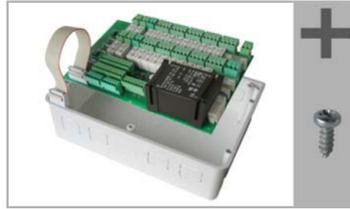
Entfernen Sie zum Montieren des Unterputzkastens die Platine und bewahren Sie sie an einem schmutzgeschützten Ort auf. **Sie darf niemals Staub oder Feuchtigkeit ausgesetzt werden!**
