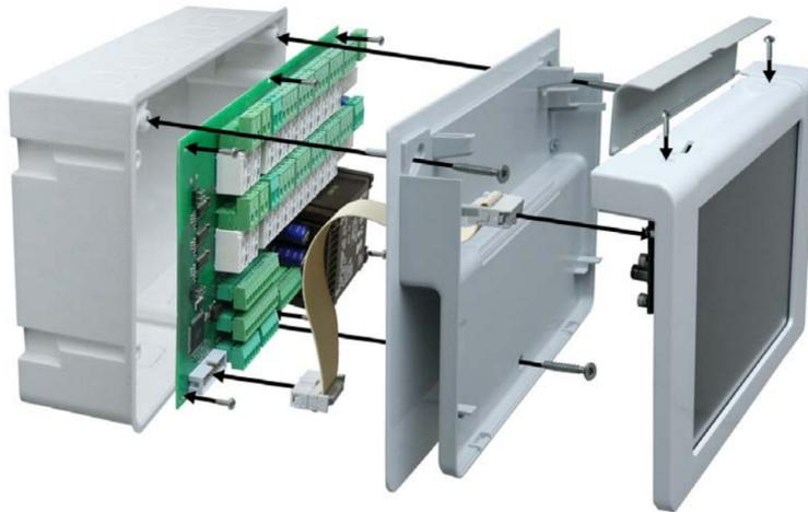
Nach der Verkabelung schrauben Sie das Gehäuseunterteil (mit der Montageplatte) auf den Unterputzkasten. Schließen Sie das Flachbandkabel am Display an.
