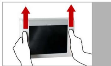
Schieben Sie das Gehäuseoberteil (Rahmen mit Display) etwas nach oben und heben Sie es ab.
